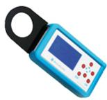
Urządzenie programujące służące do odczytywania i ustawiania adresów opraw oświetleniowych zgodnych z systemem TM-CB A lub DATA 2/DATA 2 RADIO.
